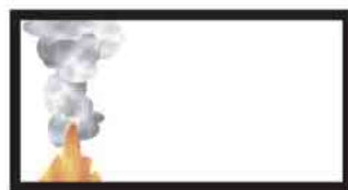
Gebäude ohne RWA A building without SHEVS
